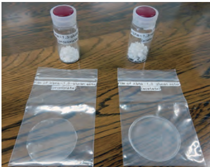
試作したフィルム。左が \alpha -1, 3-グルカンプロピオネート、右が \alpha -1, 3-グルカンアセテート
